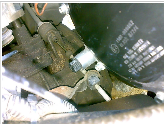
Em detalhe: ajuste de sensibilidade no redutor.
